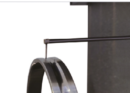
Измерение дорожки качения подшипника Pt, Ra
