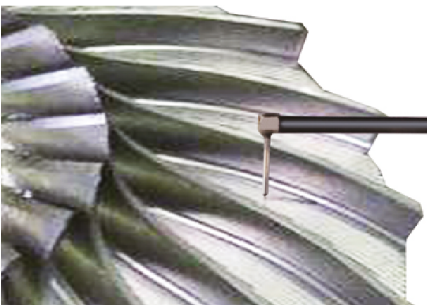
Измерение поверхности лопасти Ra
