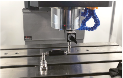
Измерение округлости станка (рис. 2)
