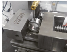
Измерение шарико-винтовой пары
