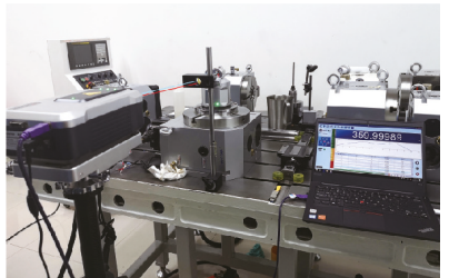
Измерение угла индексирующей пластины с числовым программным управлением
