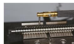
Измерение шарико-винтовой пары
