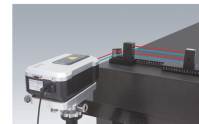
Измерение плоскостности мраморной платформы
