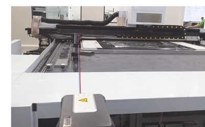
Измерение прямолинейности оборудования
