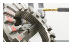
Измерение формы зубчатой шайбы
