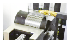
Измерение резьбы деталей
