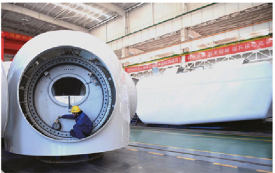
Монтаж ветроэнергетического оборудования
