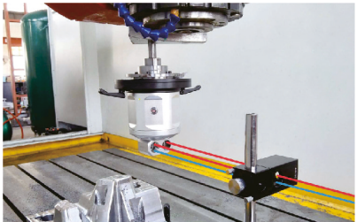
Измерение электрического шпинделя на станке с числовым программным управлением
